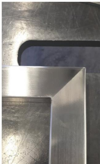
Esempio di accoppiamento saldatura e satinatura di scatolati inox.
